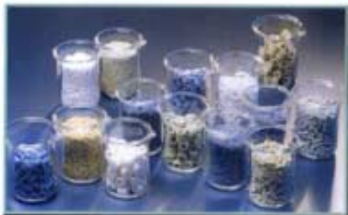
Fig 5 Forskellige industrielt anvendte heterogene katalysatorer. Katalysatorer er underkastet særlige formgivningsmetoder for at sikre optimal drift.
