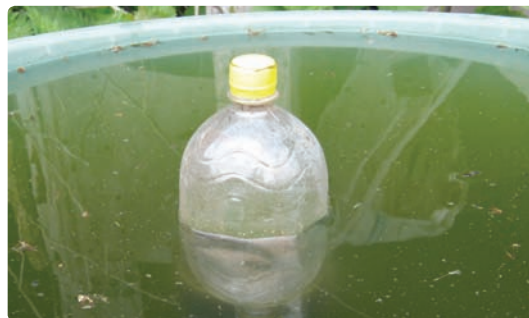
Figur 4 Svingende vanddunk med varierende mængde sand og grus. Svingningstider målt med tre forskellige masser: 1,677 kg, 1,742 kg og 1,844 kg. Diameter 9,8 cm. Som med reagensglasset er det relativt vanskeligt at få vanddunken til at svinge med acceptabel grad af stabilitet. Er der for lidt sand i, vipper den over og lægger sig skråt i vandet. Er der for meget i, ligger den for dybt og antagelsen om konstant tværsnitsareal er truet, da toppen af vanddunken runder indad mod skruelåget.
