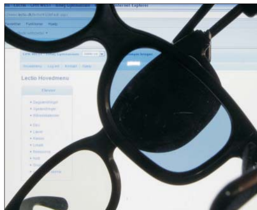
Figur 4: Når RealD-brillen holdes vandret foran skærmens lineært polariserede lys observeres en dæmpning af det transmitterede lys.
