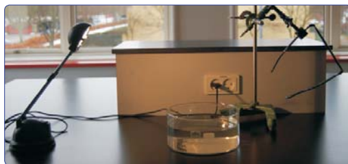
Figur 8: Opstilling til bestemmelse af den lineære polarisators transmissionsretning ved hjælp af Brewsters lov.
