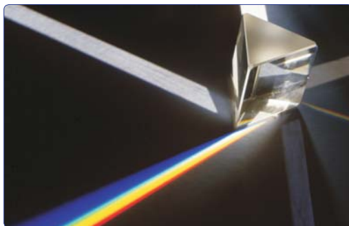
Figur 12: Et af de mest velkendte eksempler på brydningsindeksets afhængighed af bølglængde. Kilde: www.physics.uiowa.edu/~umallik/adventure/physoptics/prism.jpg .
