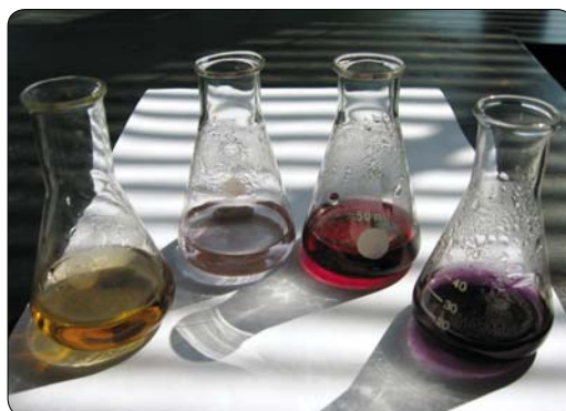
Figur 2. Guld-kolloider i forskellige farver. Kolberne indeholder kolloider bestående af guldparkler med fire forskellige partikelstørrelser. Guldparklernes størrelser er, fra venstre: 2-3 nm (gul), 5 nm (bleg pink), 10-12 nm (rød) og 18-20 nm (mørk lilla).
