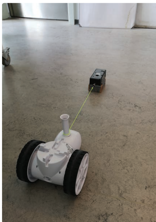
Figur 5 Robotten trækker en træklods ved konstant fart, mens friktionskraften måles. Her vist med trådløs kraftmåler, men et almindeligt Newtonmeter kan også bruges.
